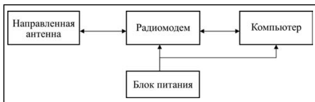
Рис. 2. Структурная схема пункта управления
