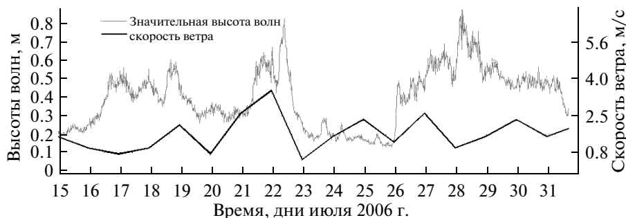
Рис. 8. График высот значительных волн (серая линия), рассчитанных с использованием негидростатической поправки, по данным, полученным вблизи м. Острый и скорость ветра (черная линия) по архивным данным, полученным в ближайшем населенном пункте (Долинск).
