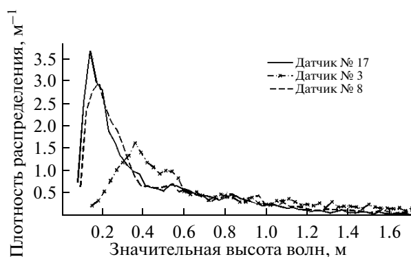
Рис. 9. Плотность распределения вероятности по записям, полученным в районе оз. Изменчивое, содержащим около 1 млн. волн.
