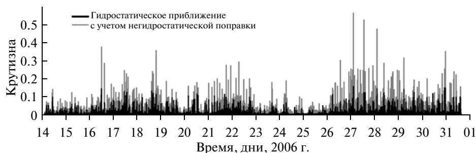
Рис. 6. Оценка крутизны волн при использовании гидростатической формулы (черная линия) и с учетом негидростатической поправки (серая линия) по данным, полученным вблизи м. Острый в 2006 г.
